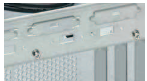
Rückseitig ausbrechbare Schnittstellenfelder
